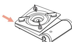
①しる受けの電極切り欠き部を電極の位置に合わせ、しる受けの角を左図の矢印部分に合わせます。
