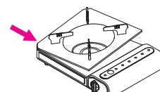
①しる受けの四隅のうち角が欠けている2箇所をボンベ側とは反対に向かって、まず矢印部分を合わせます。
