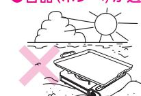
夏の砂浜やアスファルトなど日光によって容器(ボンベ)が過熱するような場所では使用しないでください。
